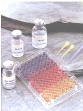
**Figura 3. Bioensayo de Met-Plate®.** Se observa en la figura una placa con los 96 micropocillos y las distintas coloraciones de las muestras ensayadas en función de la concentración del compuesto
